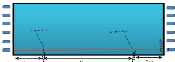
شکل ۱- نحوه نصب میله های عمودی برای ارزیابی تواتر و طول ضربه در کنار استخر
